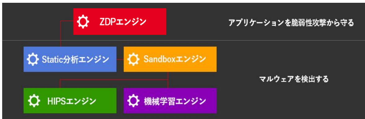
図 4 yarai 構成図 引用元 (FFRI (2018). 「[CODE:F]未知の脅威の"先読み防御"技術」)
